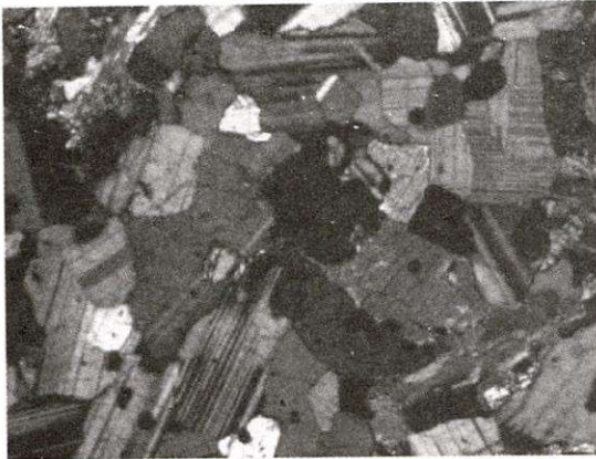
Ảnh 13. Lm HM3/1. Gabro có olivin là đá từ plagioclas có dạng lăng trụ ngắn, trình độ tự hình của plagioclas với pyroxen ngang nhau ( 2Ni^+ ; 3,3x4^x )
