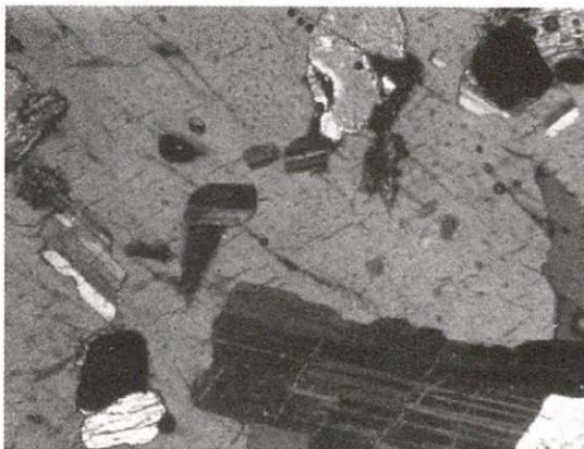
Ảnh 5. Lm HD1. Đá monzogabrodiorit, orthoclas thay thế bao bọc plagioclas, pyroxen và khoáng vật quặng ( 2Ni^+ ; 3,3 \times 4^x )
