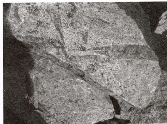
Ảnh 4. Mạch spersatit màu xám sẫm xuyên cắt vào monzonit và bị mạch pecmatoid màu trắng hồng xuyên cắt qua (vết lộ HD2)
