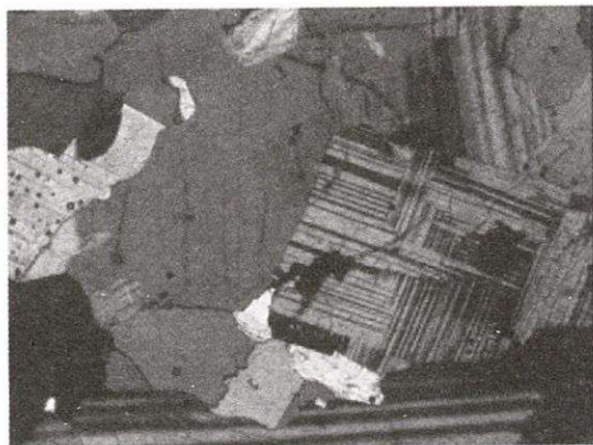
Ảnh 7. Lm HD1. Đá monzogabrodiorit, plagioclas thể hệ I có cấu tạo hợp tinh periclin ( 2Ni^+ ; 3,3x4^x )
