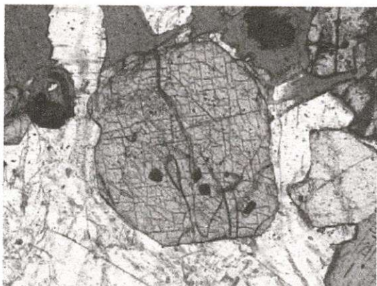
Ảnh 9. Lm HQ1/1. Đá monzodiorit, pyroxen (tiết diện 2 phương cát khai) bị biotit thay thế gặp mòn (1Ni; 3,3x4 x )
