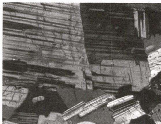
Ảnh 6. Lm HD1. Đá monzogabrodiorit, plagioclas thể hệ I có kích thước lớn chiếm phần lớn ảnh chụp, các tiết diện plag nhỏ hơn phân bố ven rìa pla ( 2Ni^+ ; 3,3 \times 4^x )
