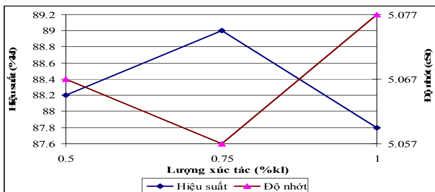
Hình 4. Khảo sát ảnh hưởng hàm lượng xúc tác đến hiệu suất thu biodiesel và độ nhớt sản phẩm.
