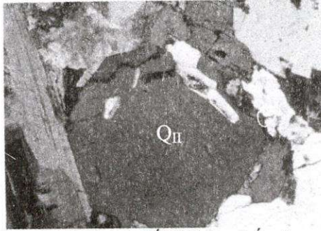
Hình 11. Thạch anh thể hệ II thay thế, găm mòn plagioclas thể hệ I lm BV1/1, 2Ni+, 3.3 x 4 X QII: thạch anh thể hệ II
