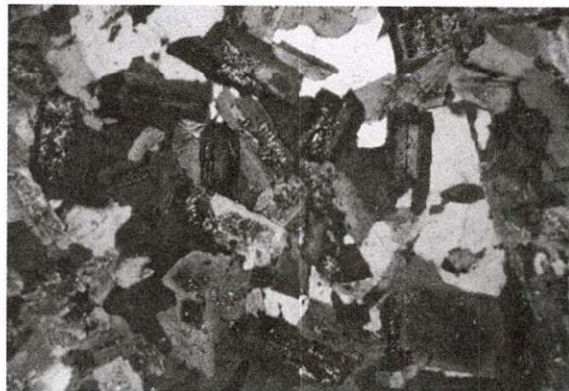
Hình 12: Plagioclas phân đới bị saussorit hóa ở nhân, thạch anh (màu trắng) gặm mòn và bao các khoáng plagioclas.
