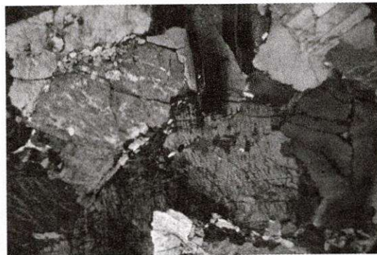
Hình 6: Plagioclas phân đới bị felspat kali hóa tạo microclin mọc xen với albit (perthit) (Lm LH7, granit biotit, 2 + , x10)
