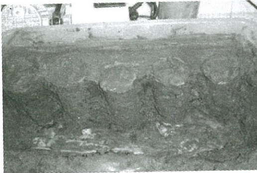
Hình 2. Mẫu đất thí nghiệm sau khi lấy ra khỏi thùng bảo dưỡng.
