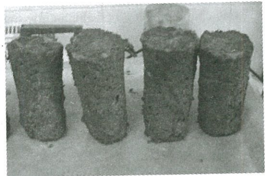
Hình 2. Mẫu đất thí nghiệm sau khi lấy ra khỏi thùng bảo dưỡng.
