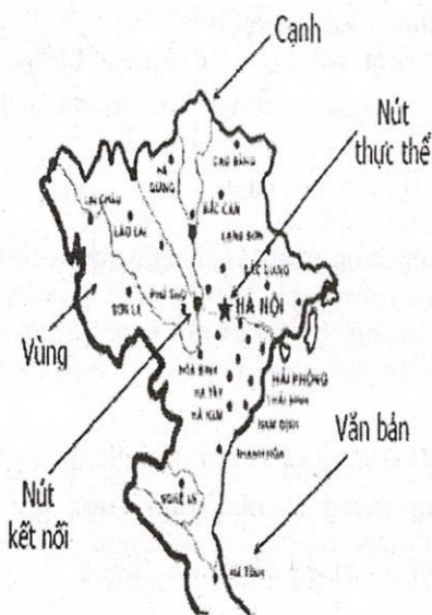
Hình 8. Các đối tượng hình học cơ sở trong mô hình Topology minh họa cạnh, vùng, nút kết nối, nút thực thể, văn bản
