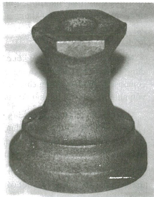
Hình 4 : Ảnh chi tiết AKAMA đúc trong khuôn cát nhựa có dùng sơn chống cháy dính trên cơ sở ziricôn, cho bề mặt vật đúc láng sạch.
