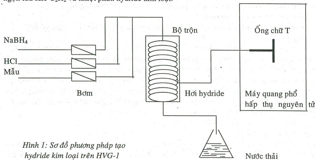
Hình 1: Sơ đồ phương pháp tạo hydride kim loại trên HVG-1
